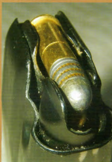
Principe du "chargeur-gigogne", celui du 22 LR, plus étroit, étant pincé dans celui du 9 mm, plus large. On voit bien le principe de la double paroi, dont l'interne présente la cartouche de .22 LR.
