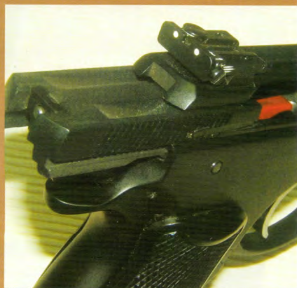
La fine culasse recule sous une ligne de visée qui reste fixe, du guidon à la hausse réglable. La planchette élévatrice (en rouge) du chargeur positionne bien la cartouche face à la chambre.
